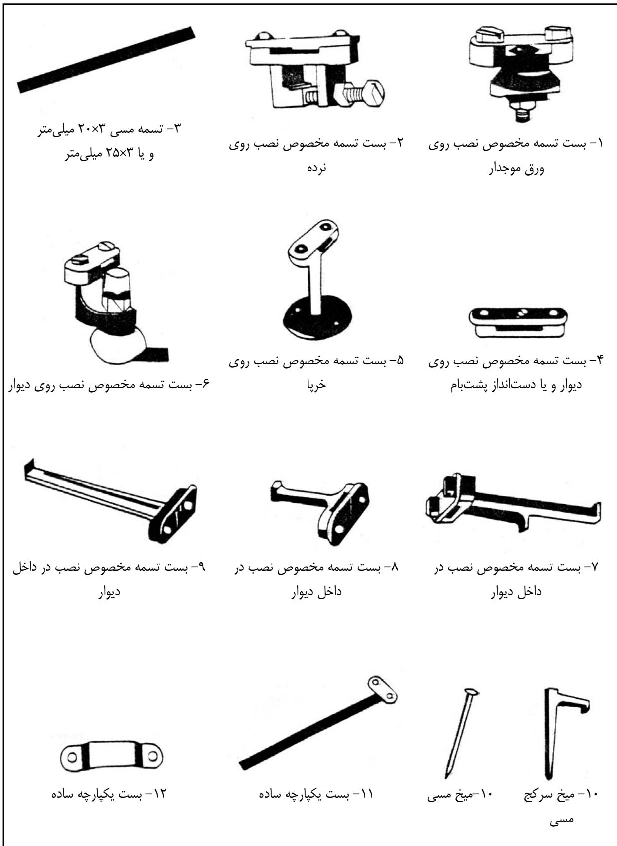
شکل ۱۴-۱۲: اتصالات و وسایل مختلف تسمه‌کشی
